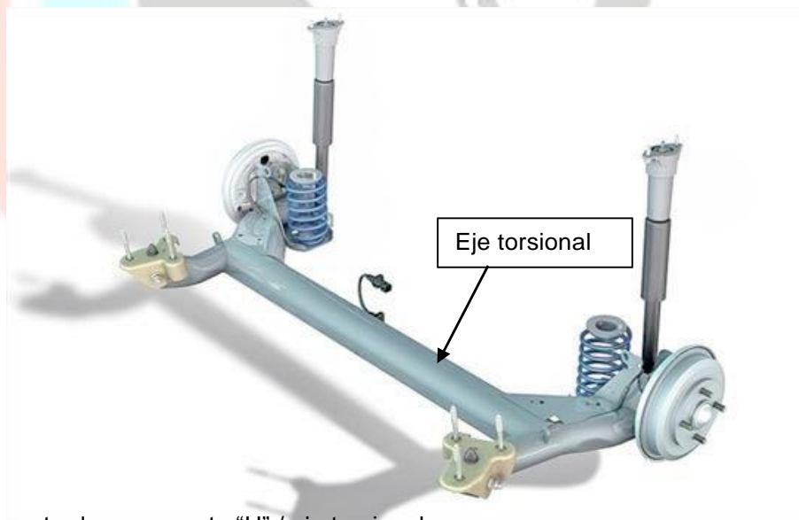
Brazo arrastrado con puente "H" / eje torsional.
