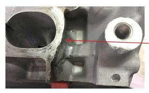
Se permite rellenar conductos, cilindro 1-2-3-4.
