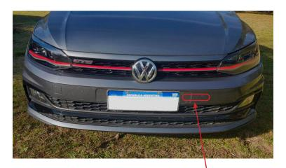
Se permite cortar el paragolpes para el ingreso de aire a la toma dinámica medida máxima 310mm x 51mm
