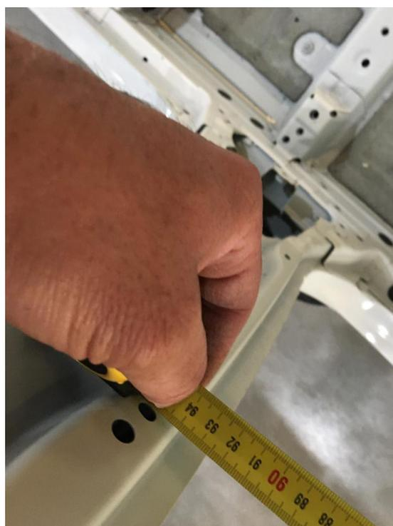
La altura del anclaje del amortiguador trasero será libre, la distancia longitudinal será de 940 mm dicha distancia es paralela a la línea media del vehículo, se toma del centro del amortiguador original hasta la parte trasera del parante, descontando la pestaña y a la altura del tornillo interior de la visagra trasera
