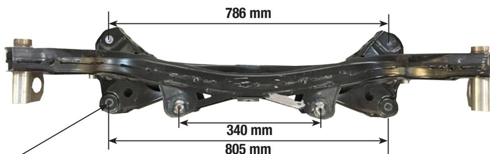
Anclaje tensor inferior en el cual se puede realizar el movimiento microgiro según inciso (C)
