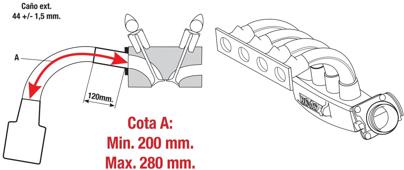
Múltiple de admisión, caja mariposa son homologadas por la categoría. Dentro de la cota A tiene 120 mm. de libre diseño luego de dicha medida el caño debe mantener su sección constante con su respectiva tolerancia. Se puede pulir la boca del plenum hasta un diámetro máximo de 61,5 mm. y con una profundidad máxima hasta el centro de la primera boca de admisión comenzando del apoyo de la caja mariposa.
